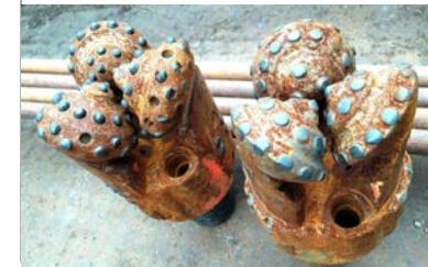
掘削に使われたドリルビット(刃先) 硬い岩盤により摩耗しています
