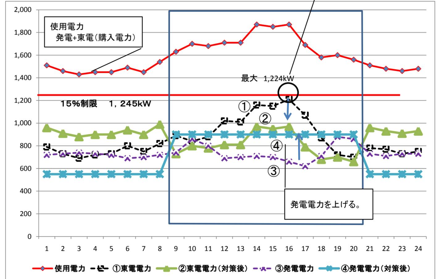
当組合は、東京電力と発電電力の合計電力が使用電力となります。そのため、発電電力を上げることで東京電力側は、削減となります。(グラフ参照)
