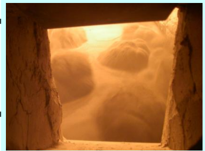
焼却炉内部 (砂が流動している状態)
