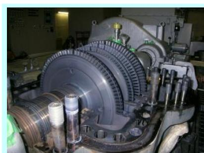
蒸気タービン発電機（内部）
