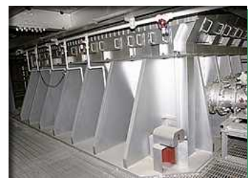
焼却炉 (流動床炉)
