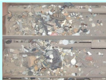
不燃物搬送コンベヤ (不燃混合物)
