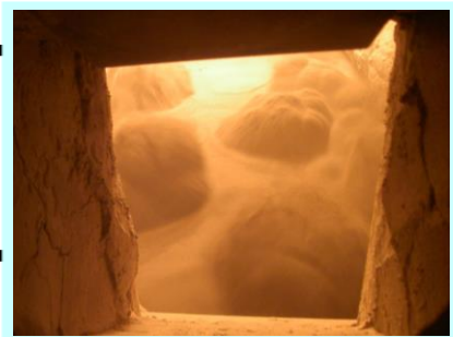
焼却炉内部 (砂が流動している状態)
